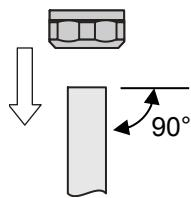
**RU** Разрежьте пластиковую, медную или многослойную трубу под прямым углом, зачистите и откалибруйте ее. Наденьте накидную гайку на трубу.
