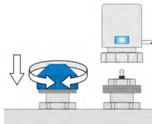
**RU** После окончания регулировки защитный колпачок или сервопривод устанавливаются на регулирующий клапан, препятствуя, таким образом непроизвольному изменению настройки или загрязнению клапана.
