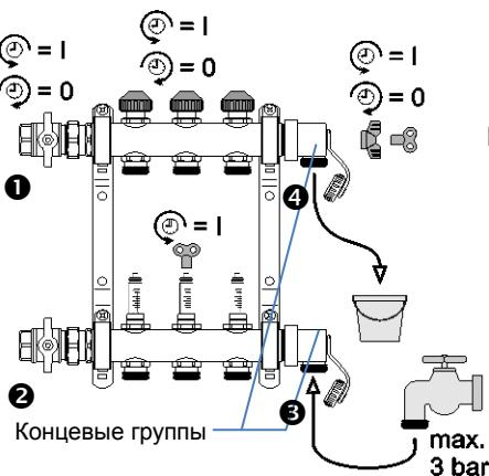
**RU** Закройте шаровые краны ① + ②. Закройте все регулирующие клапаны при помощи пластиковых колпачков (вращение по часовой стрелке до упора). Подключите шланг для наполнения и промывки к сливному крану концевой группы ③ подающего патрубка; сливной кран ④ концевой группы обратного патрубка должен быть полностью открыт!
