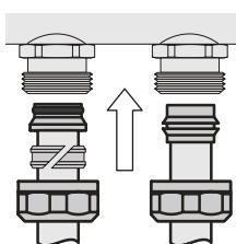
**RU** Вставьте готовую к монтажу трубу до упора в резьбовое соединение коллектора.
