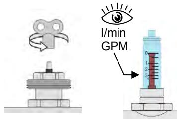
**RU** Необходимый расход теплоносителя устанавливается поворотом регулировочного шпинделя клапана на обратном патрубке коллектора. Фактическая величина расхода теплоносителя контролируется по показаниям расходомера.
